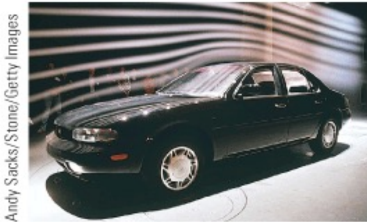
Figura 14.13 Flusso laminare che avvolge un'automobile durante una prova nella galleria del vento.
