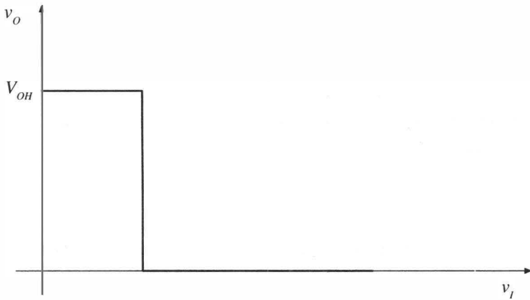
Figura 6.11 Funzione di trasferimento ideale di una porta NOT
