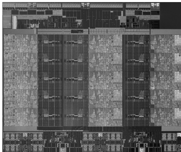
Processore Intel® con architettura Ivytown. Il processore contiene 4.3 miliardi di transistori, 15 core e 37.5 MB di cache L3 realizzata con tecnologia Intel da 22 nm 9-metal Hi-K tri-gate con gate metallico. [Stefan Rusu, et al. "Ivytown: A 22nm 15-Core Enterprise XeonProcessor Family" 2014 IEEE International Solid-State Circuits Conference, per gentile concessione di Intel Corporation.]
