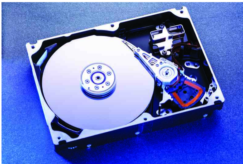
Figura 11.2 Disco da 3,5 pollici senza la sua copertura.
